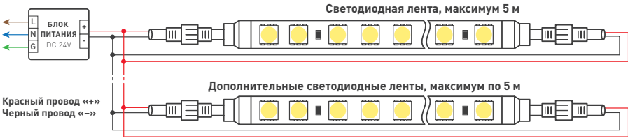
Схема 2. Подключение нескольких светодиодных лент «грейзер» с двух сторон. Рекомендуется использовать для обеспечения равномерного свечения ленты по всей длине
