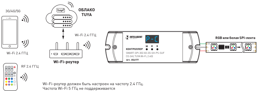
Рис. 2. Общая структурная схема построения системы управления освещением
